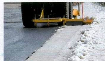
Главное в испытаниях на слякшпленинг — подготовка равномерного слоя мокрого снега. Без специальной техники стабильных результатов не получишь
