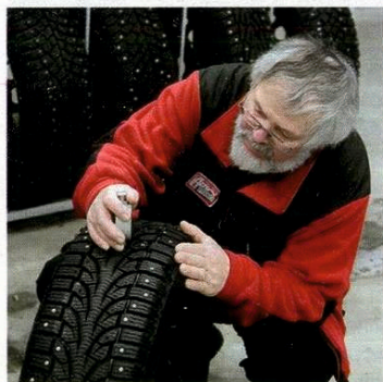
Перед испытаниями — замеры глубины рисунка протекторов, твердости резины и выступания шипов над поверхностью протектора
