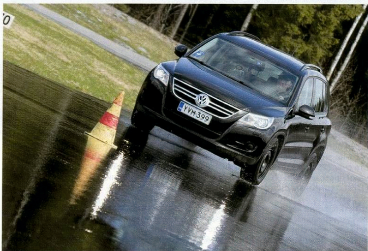
На мокром асфальте минимальный тормозной путь обеспечивают шины Gislaved, а на сухом — Yokohama
