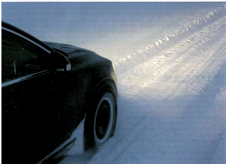
После снегопада мы смогли провести замеры разгонной динамики автомобиля в глубоком снегу — лучше других «гребут» шины Nokian, Nordman и Yokohama
