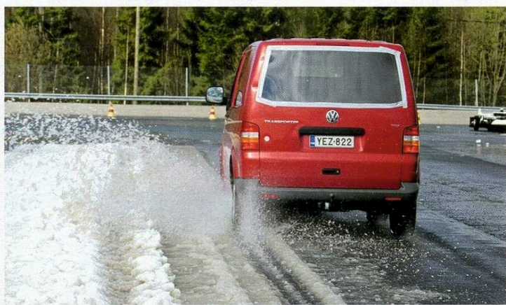
Испытания на сопротивление слякшпленингу: Volkswagen Transporter въезжает левыми колесами на полосу мокрого снега, водитель утапливает педаль акселератора в пол, и автомобиль разгоняется до тех пор, пока ведущее переднее колесо не сорвется в пробуксовку — аппаратура фиксирует скорость, которую и принято называть скоростью начала слякшпленинга
