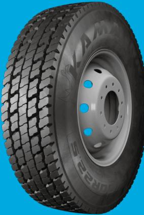
Грузовые шины Кама NR 202 разработаны для применения на задней (ведущей) оси грузового и коммерческого грузового транспорта, осуществляющего перевозки по местным и региональным дорогам.
