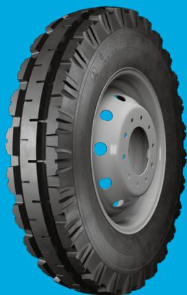
Сельскохозяйственные Кама В-103 диагональной конструкции предназначены для установки на направляющие колёса тракторов «Беларусь» МТЗ-50 и МТЗ-80, а также Т-40А, ЮМЗ-6Л и других аналогичных моделей.
