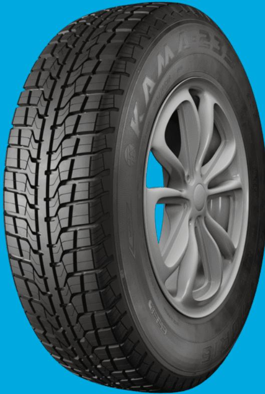
Шины Кама 235 разработаны для использования на полноприводных автомобилях - внедорожниках и кроссоверах на дорогах общего пользования и бездорожью.
