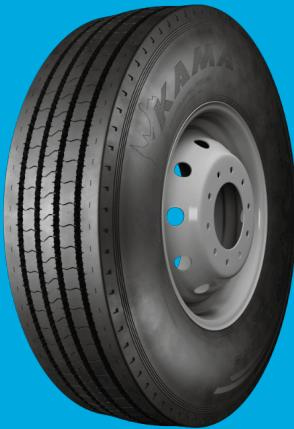
Грузовые шины Кама NF 201 предназначаются для установки на переднюю (рулевую) ось грузового и коммерческого транспорта, передвигающегося преимущественно по дорогам с твёрдым покрытием в пределах города или по региональным трассам.
