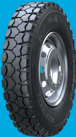
Грузовые шины КАМА NU 901 предназначены для применения на всех осях грузовых автомобилей при соблюдении скоростной и нагрузочных характеристик, соответствующих даннойшине, преимущественно на строительных площадках, на дорогах с усовершенствованным облегченным покрытием и переходных, на покрытых снегом дорогах при температуре окружающей среды от -45 до +55 градусов.
